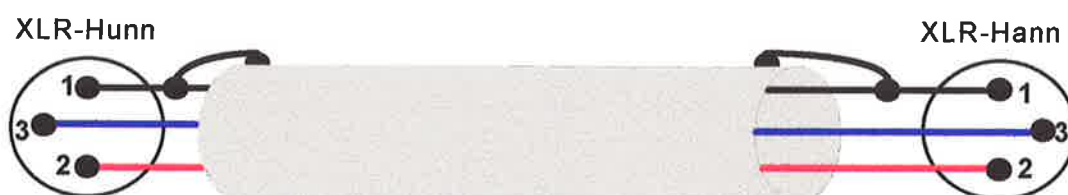
Figur 3. Balansert til balansert XLR-kabel.
