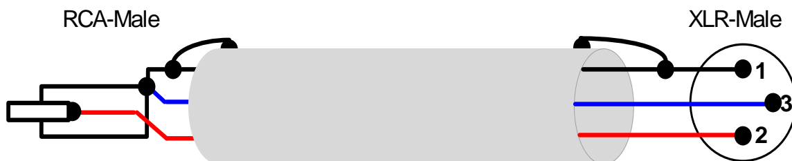
Figur 4: Ubalansert til balansert kabel
