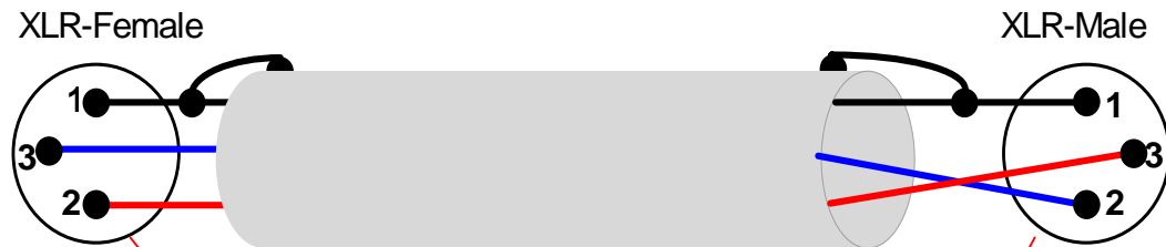
Figur 5: Spesialkabel for brokobling av kraftforsterker.
