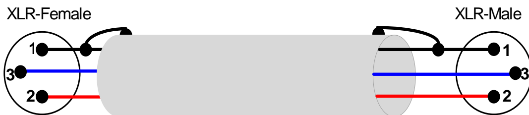
Figur 3: Balansert til balansert XLR-kabel.
