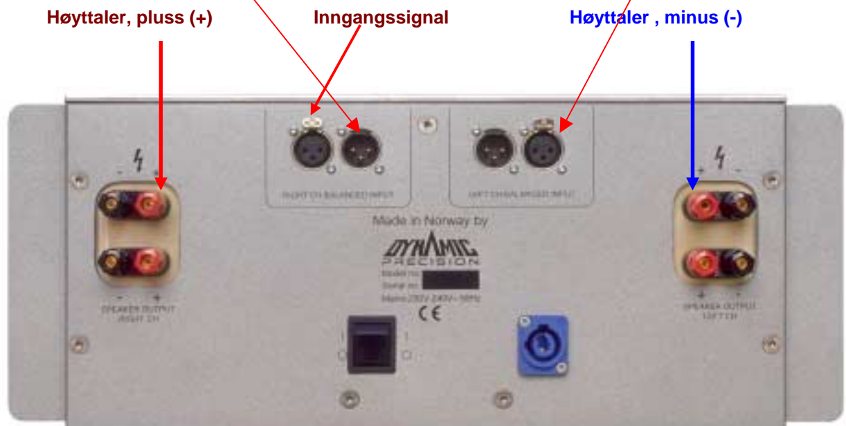
Figur 6: Brokobling via spesialkabel.
