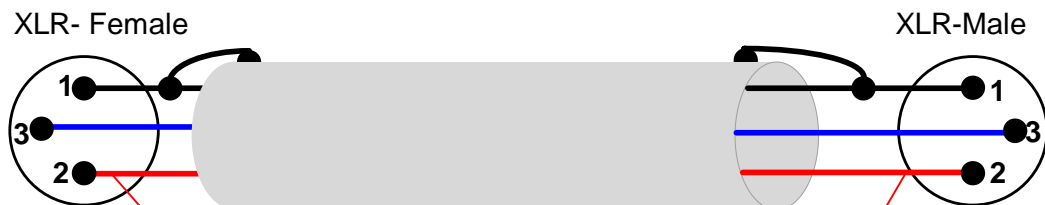
Figure 8: XLR-kabel for monokobling av kraftforsterker.
