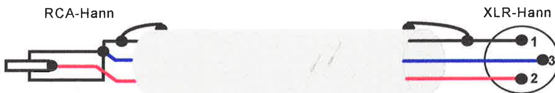
Figur 4: Ubalansert til balansert kabel
