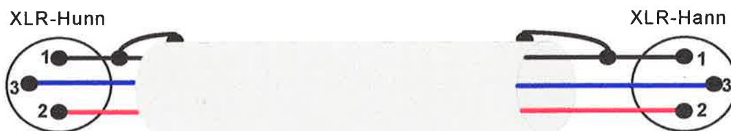
Figur 3: Balansert til balansert XLR-kabel.
