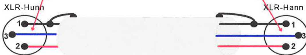
Figur 8 XLR-kabel for monokobling av kraftforsterker.
