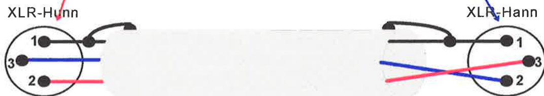
Figur 6 Spesialkabel for brokobling av kraftforsterker.
