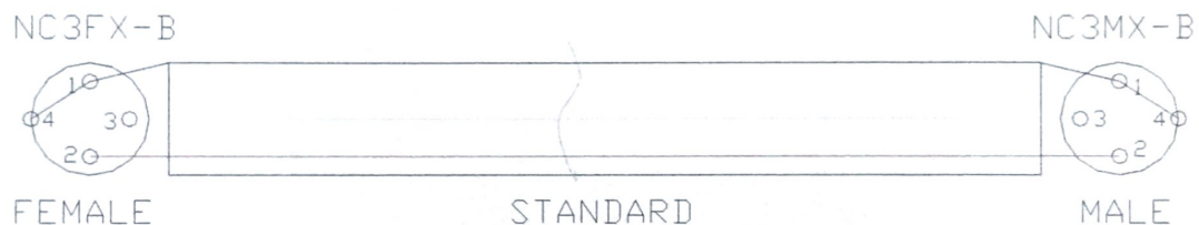
Figur 3: Kabel for kobling mellom balanserte inn og utganger(XLR XLR-kabel).
