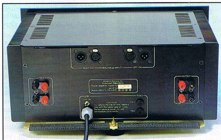
DP 6.12 effektforsterkeren har magisk bryter, fast nettledning, kun balanserte inn- og utganger for ett sett høvtalere. Kan også kjøres ubalansert, med over-
