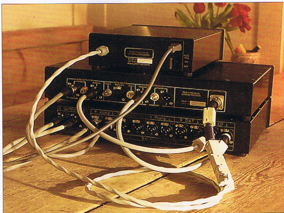
Baksiden av forforsterkeren og DA-konverteren. Her ser du kabler med ferritblokker og egen jordingskabel mellom forforsterkeren og DA-konverteren. Signalkabelen fra forforsterkeren til effektforsterkeren (neders til venstre) er tvunnet for å redusere høyfrekvent støy.
